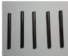
Gambar2. Sampel Baja Tulangan beton yang telah melalui proses coating.
