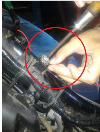
Gambar 7. Pemasangan Kabel Ground
