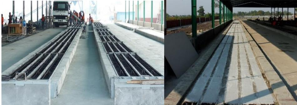
Gambar 7. Contoh cetakan produksi tiang mikropile beton prestress
