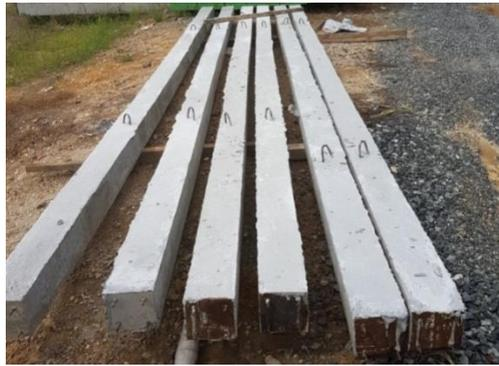
Gambar 6. Prototype bahan jadi tiang uji mikropile beton
