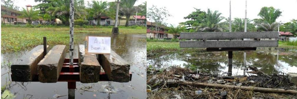
Gambar 8. Pelaksanaan pengujian pembebanan prototype mikropile beton
