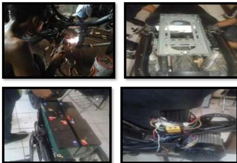
**Gambar 2.** Proses pemasangan *electric motorcycle management system* pada Shogun SP125
