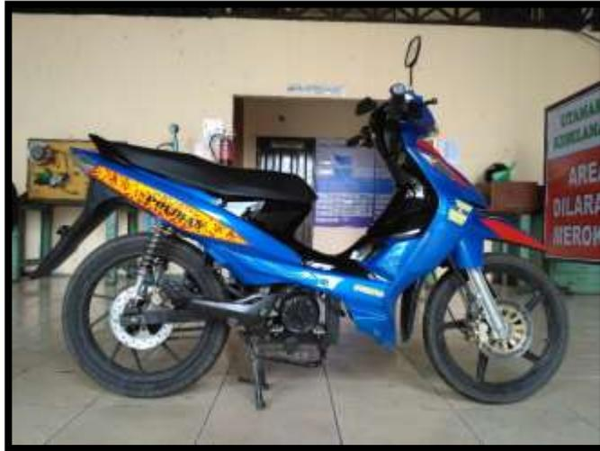
**Gambar 4.** Hasil modifikasi Suzuki Shogun SP125 menjadi Sepeda Motor Listrik
