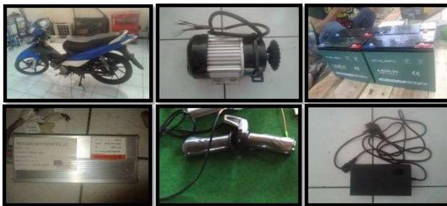
**Gambar 1.** Komponen utama sepedamotor listrik
