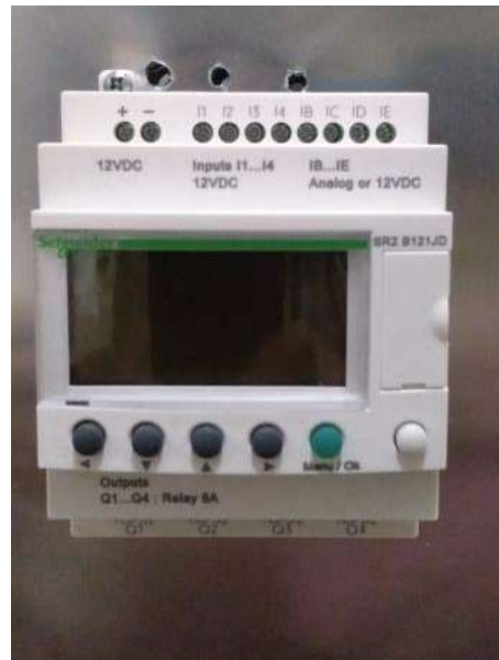
Gambar 12. Pemasangan Smart Relay Zelio
