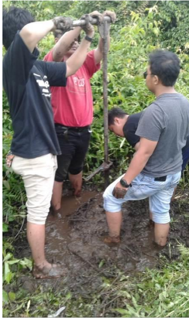
Gambar 2. Pengeboran dangkal menggunakan alat uji Handbored untuk memperoleh sampel UDS.
