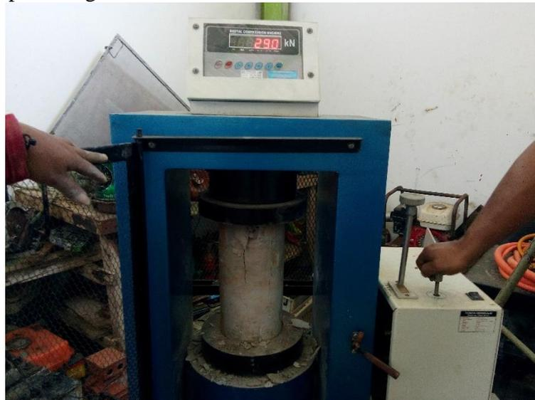
Gambar 6. Pengujian sampel beton
