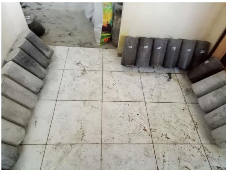
Gambar 5. Pengeringan Sampel Beton
