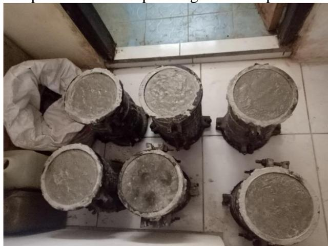
Gambar 3. Persiapan Pelepasan Cetakan
