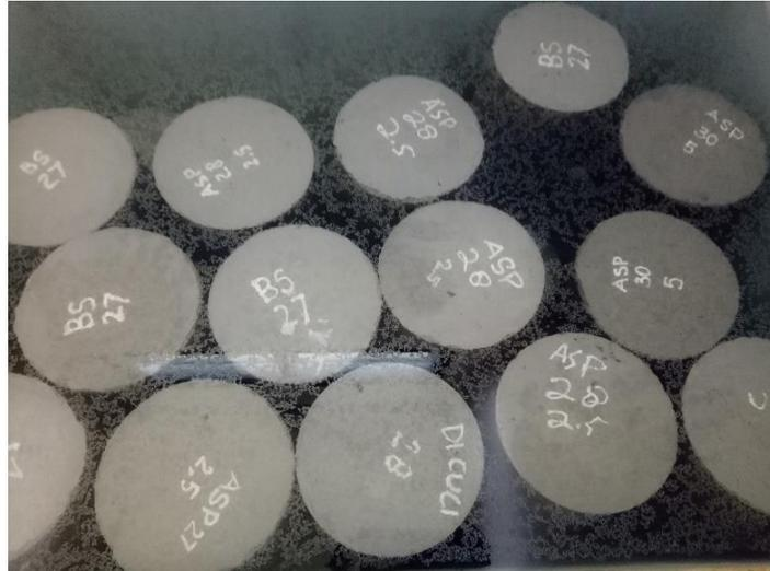
Gambar 4. Perawatan Sampel Beton
