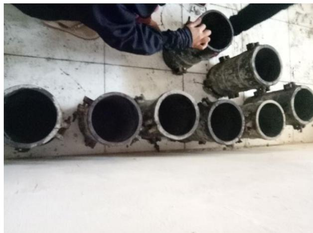
Gambar 1. Pemasangan dan pemberian oli pada cetakan
