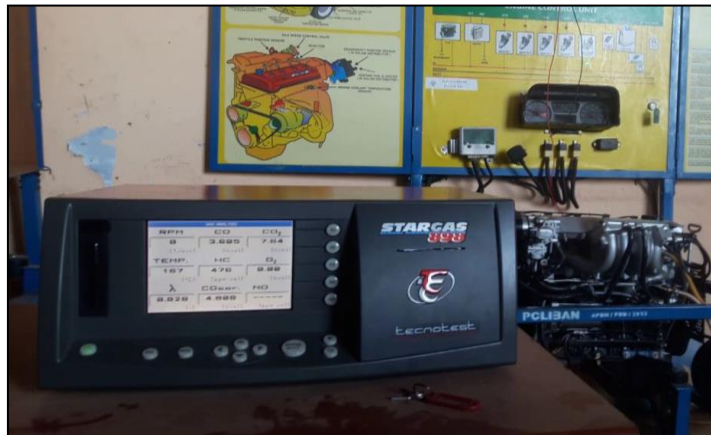
Gambar 5. Pengujian emisi gas buang dengan gas analyser
