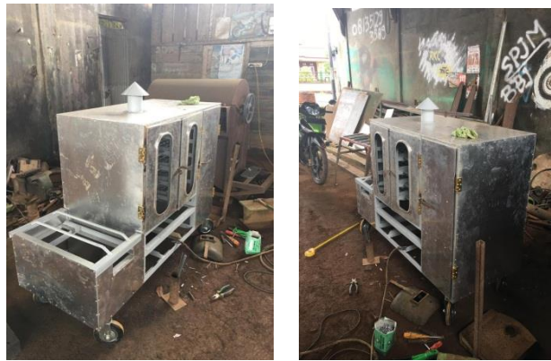
Gambar 2. Tahap perakitan alat oven asap portabel di workshop
