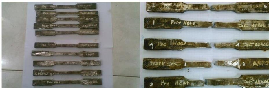
Gambar 7 Specimen sudah di uji tarik
