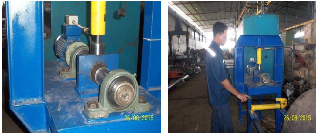
Gambar 6. Alat bantu kerusakan anti-friction dan saat uji coba
