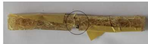
Gambar patahan prosentase 45% daerah takikan specimen uji impact
