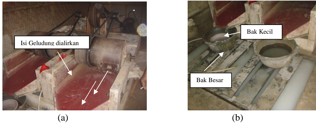
Gambar 3 Pendulangan Amalgam; (a) Amalgam dan Tailing Dituang Ke Bak (b) Bak Untuk Pendulangan Amalgam
