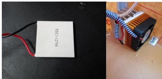
Gambar 5. Elemen Pemanas TEC1-12706 yang Terpasang pada Tabung inkubator
