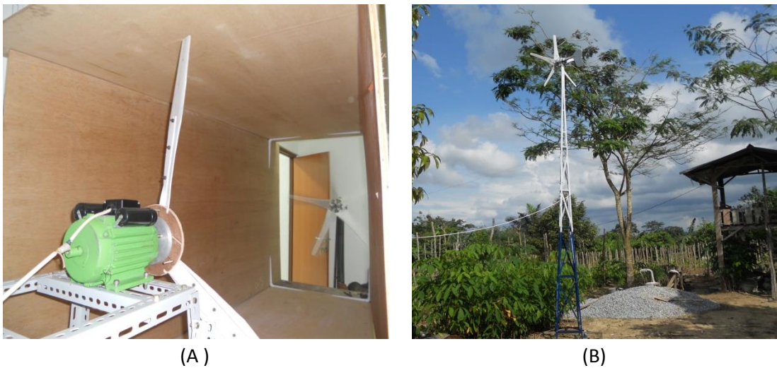
Gambar 5. A. Pengujian di Laboratorium menggunakan terowongan angin B. Suasana Pengujian Pembangkit di kebun lada
